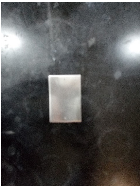
Slika 1. – Izgled kupona od nerđajućeg čelika EN-1.4301
