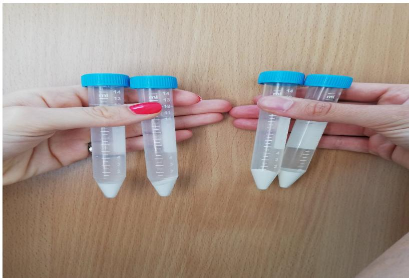
Slika 6. Proizvod koprecipitacije nakon centrifugiranja
