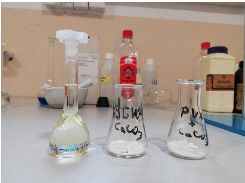
Slika 7. Etanolni rastvor vitamina D<sub>3</sub> i tikvice sa nosačima
