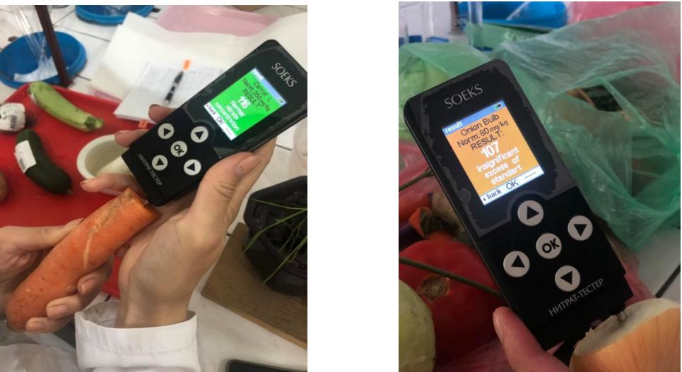
Slika 1. i 2. Mjerenje nitrata pomoću nitrat testera
