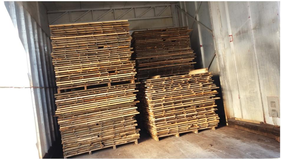
Slika 13. Palete piljene građe unutar parionice
