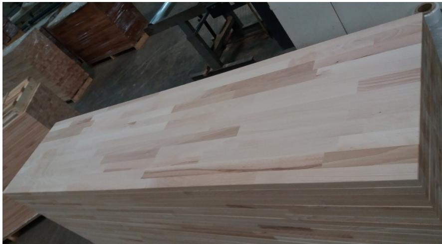
Slika 41. Ploče nakon brušenja spremne za nauljavanje
