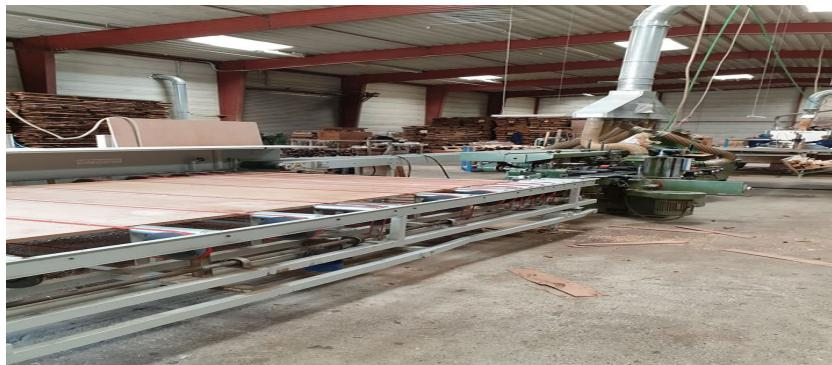
Slika 20. Transportni mehanizam za prijenos elemenata do poprečnih cikulara
