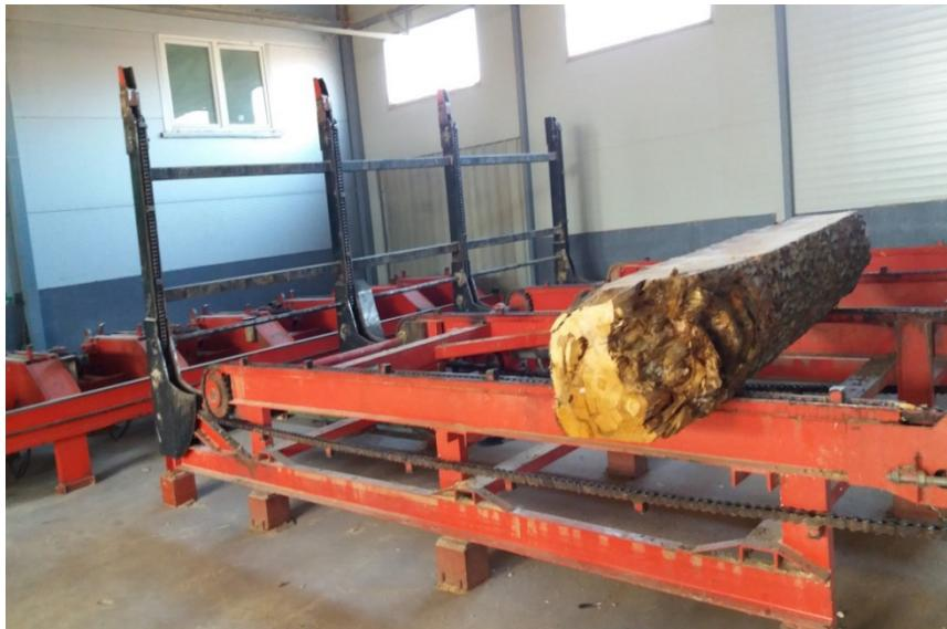
Slika 7. Mehanizam na transporteru za prijenos trupca na tračnu pilu
