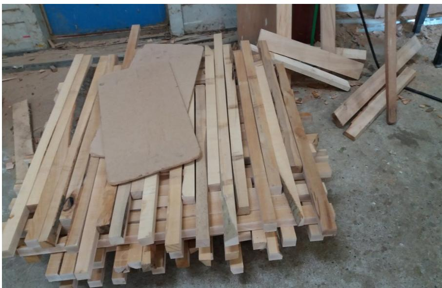
Slika 18. Elementi, odnosno drveni profili dobiveni raspiljivanjem piljenica višelisnim cikularom
