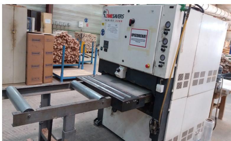
Slika 40. Protočna brusilica
