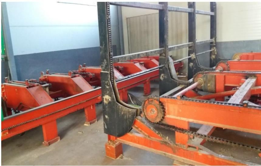
Slika 8. Metalni nosači sa glavom za prijenos trupca sa lančanog transporterja na tračnu pilu i dio tračne pile za prihvatanje trupca
