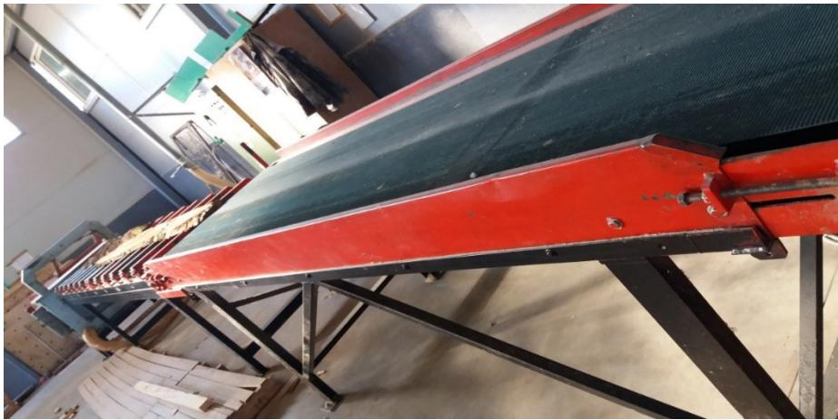
Slika 11. Transportna traka za prihvati piljenica sa tračne pile, valjkasti transporter bez pogona za prihvati piljenica sa tračne pile, cikular za poprečno rezanje piljenica, te valjkasti transporter bez pogona za prihvati piljenica sa cikulara
