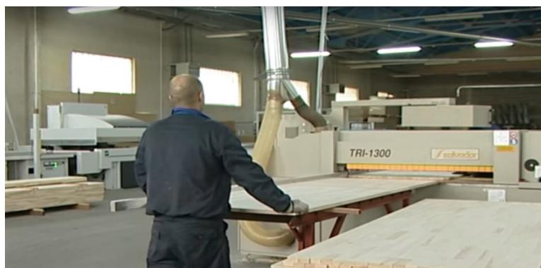
Slika 39. Formatni štuc za poravnjanje i rezanje ploča
