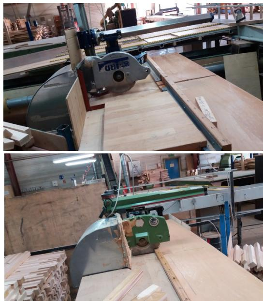
Slika 21. Cikulari za poprečno raspiljivanje elemenata
