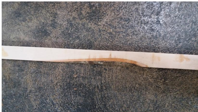
Slika 22. Element koji ima koru na svojoj površini, a koji je potrebno obraditi cikularom
