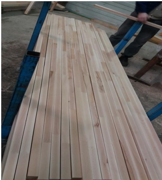
Slika 36. Slaganje lajsni nakon obrade na četverostranoj blanjalici
