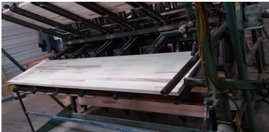
Slika 38. Presa za spajanje ili ljepljenje lajsni po širini
