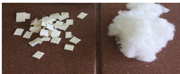
Slika 2. Uzorak celuloze: nedefibriran (lijevo), defibriran (desno)
