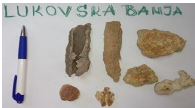
Slika 5. Uzorci inkrustrativnih naslaga ispitanih metodom rendgenske difrakcije praha (Šaraba i Krunić, 2017, u štampi)
