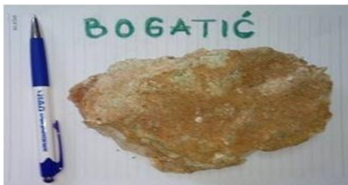
Slika 6. Ispitivani uzorci inkrustovanih naslaga sa glave bunara BB-1 (Bogatić) (Šaraba i saradnici, 2017, u štampi)
