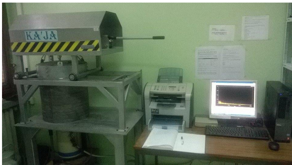
Slika 2. Aparatura za gamaspektrometrijsku analizu u laboratoriji na PMF-u u NS
