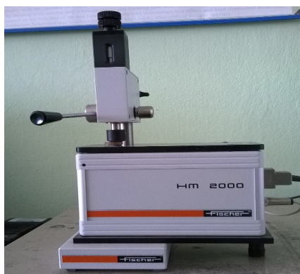
Slika 2 Uređaj Fisherscope HM 2000S kojim su vršena merenja
