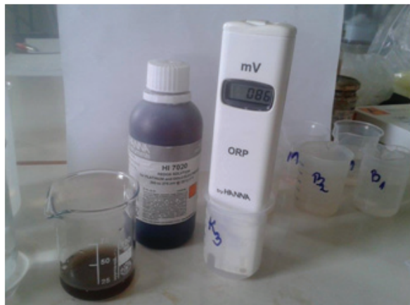
Slika 9. Tekućina za kalibraciju OBS sonde i određivanje redoks-potencijala u uzorku
