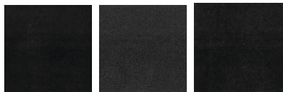
Slika 4. Kvadrati korišteni za određivanje makro neuniformnosti (redom: sjajni, ofsetni, mat)
