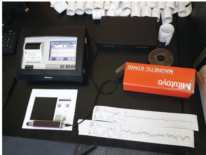
Slika 1. Mjerenje hrapavosti na instrumentu Mitutoyo SJ 310
