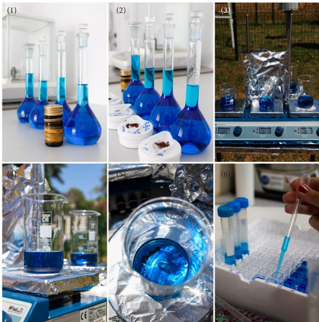
Slika br. 3. Fotografije postupaka fotokatalitičke degradacije metilen plavog. Na fotografiji (1) mogu se vidjeti standardni rastvori metilen plavog, a na fotografiji (2) i pripremljeni uzorci fotokatalizatora \text{ZnFe}_2\text{O}_4 . Na fotografijama (3), (4) i (5) pomiješani fotokatalizatori i rastvori boje su stavljeni na magnetnu mješalicu. Alikvoti na fotografiji (6) su preneseni u kivete za mjerenje pomoću UV/Vis spektrofotometrije
