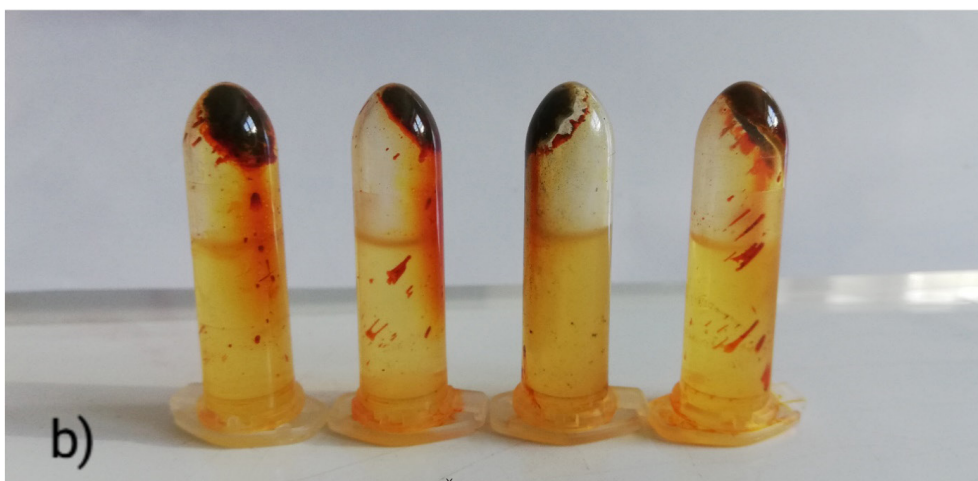
Slika broj 5. SeNC obložene polimerom Rastvor SeNC/POLY prije ispiranja destilovanom vodom i centrifugiranja Rastvor SeNC/POLY nakon ispiranja destilovanom vodom i centrifugiranja
