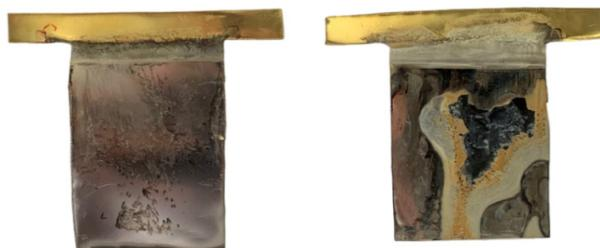
Slika 9. Uticaj miješanja na kvalitet regenerisanog nikla pri 50 o/min (lijevo) i 200 o/min (desno) ( $j = 2,5 \text{ A/dm}^2$ ,  $T = 20^\circ\text{C}$ )
